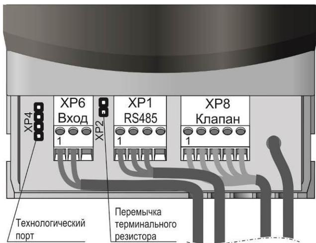
Рисунок В.4 – Расположение разъемов в клеммном отсеке.
