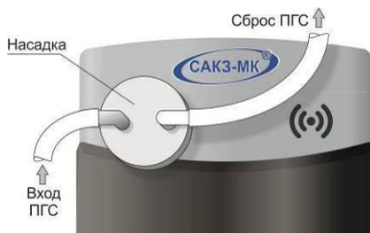
Рисунок Е.2 – Установка насадки для подачи ПГС
