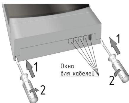
Рисунок В.2 – Снятие крышки клеммного отсека
